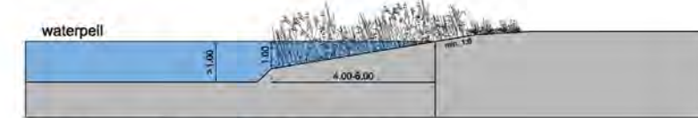
02 standaard natuurvriendelijke oever, talud min. 1:6
