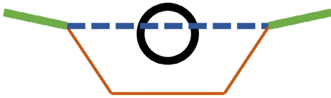
Figuur 2. Schematische dwarsdoorsnede van een watergang met een duiker die gedeeltelijk boven de waterlijn ligt
