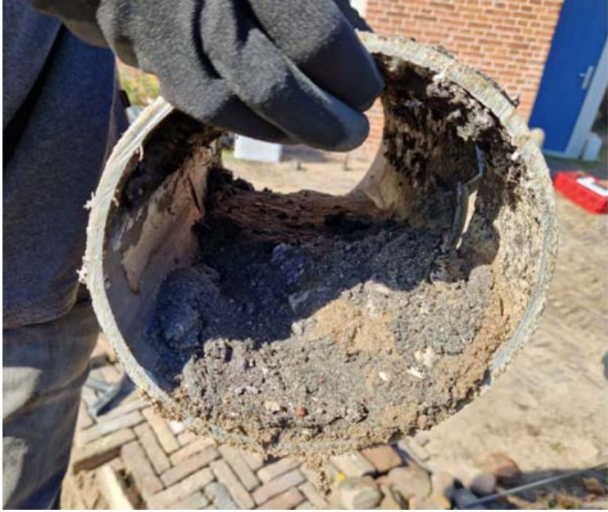
Figuur 32, riool gevuld met zand
